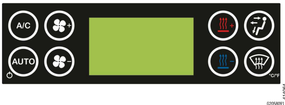
Elemento di comando riscaldamento e impianto di condizionamento
